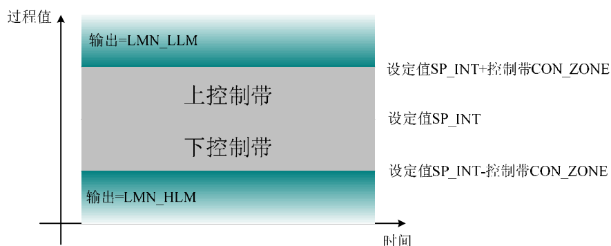
图 10 控制带（正作用情况下，即 GAIN>0.0）
